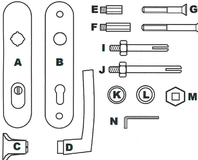
Do vnějšího štítu (A) vložte madlo (C) orientované dle typu dveří (pravé či levé). Do stejného otvoru, ale z vnitřní strany vložte ocelovou podložku s otvorem (K). Na čtyřhran (I/J) nasaděte utahovací matici a přichyťte závitem do madla. Pro dotažení nasaděte na čtyřhran kliku (D) a dotáhněte. Po dotažení odstraňte utahovací matici a kliku. Našroubujte matice M8 (E/F) a dotáhněte je stranovým klíčem.
